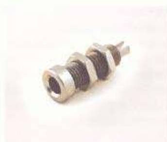
BU 4000 Einbaubuchse innen 4 mm Ø mit Lötanschluss und Außengewinde M 6x0,75 und zwei Muttern, komplett Messing vernickelt.
