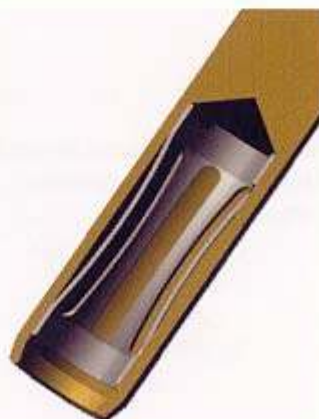
Federkorbkontakte an Steckern und in Buchsen fertigen wir stufenlos ab 1,0 mm Ø aus hochwertigem Kupferberyllium für dauerhafte Elastizität und beste Kontakteigenschaften.
