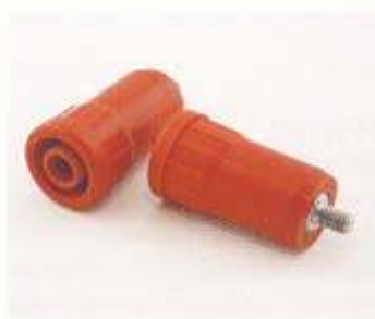
BU 4702 Sicherheitseinspreßbuchse innen 4 mm Ø mit Flansch 13,2 mm Ø zum Einpressen in Montagebohrungen von 12,0 mm Ø, Buchse aus Messing gedreht und vernickelt, mit Gewindestift M 3x4 mm, in den Farben schwarz, rot, blau, gelb, grün und gelbgrün.
