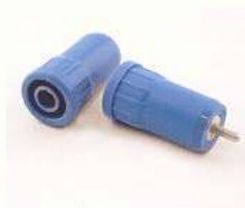
BU 4700 Sicherheitseinspreßbuchse innen 4 mm Ø mit Flansch 13,2 mm Ø zum Einpressen in Montagebohrungen von 12,0 mm Ø, Buchse aus Messing gedreht und verzinkt, mit Lötstift 2 mm Ø, 5mm lang, in den Farben schwarz, rot, blau, gelb, grün, violett, weiß und gelbgrün.
