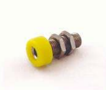
BU 4300 Buchse innen 4 mm Ø mit durchgehender Bohrung und PVC isoliertem Kopf außen 10 mm Ø mit Außengewinde M 6x0,75 und zwei Muttern, Metallteile Messing vernickelt.
