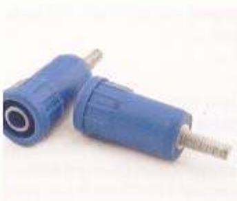
BU 4703 Sicherheitseinspreßbuchse innen 4 mm Ø mit Flansch 13,2 mm Ø zum Einpressen in Montagebohrungen von 12,0 mm Ø, Buchse aus Messing gedreht und vernickelt, mit Gewindestift M 4x10 mm, in den Farben schwarz, rot, blau, gelb, grün und gelbgrün.
