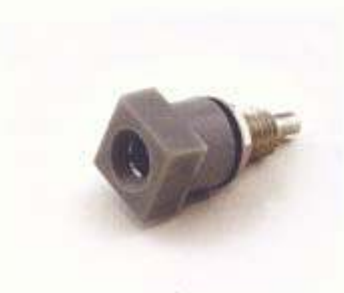
BU 4500 Buchse innen 4 mm Ø, Polyamid umspritzt mit quadratischem Kopf 12 x 12 mm für Frontplattenmontage bis 3 mm Wandstärke und Lötanschluss, sowie Außengewinde M 6x0,75 montiert mit Unterlagscheibe und Mutter, Metallteile Messing vernickelt.
