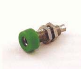
BU 4200 Buchse innen 4 mm Ø mit PVC isoliertem Kopf außen 1 mm Ø und Lötanschluss mit Außengewinde M 6x0,75 und zwei Muttern, Metallteile Messing vernickelt.
