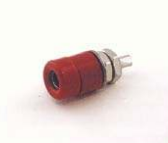
BU 4400 Buchse innen 4 mm Ø mit geschraubtem Rundkopf 10 mm Ø außen, für Frontplattenmontage bis 3 mm Wandstärke und Lötanschluss, sowie Außengewinde M 6x0,75 montiert mit Unterlagscheibe und 2 Muttern, Metallteile Messing vernickelt.
