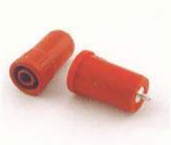
BU 4800 Sicherheitseinspreßbuchse innen 4 mm Ø mit Flansch 14 mm Ø zum Einpressen in Montagebohrungen von 12,0 mm Ø, Buchse aus Messing gedreht und verzinkt, mit Lötstift 2 mm Ø, 5mm lang, in den Farben schwarz, rot, blau, gelb, grün, violett, weiß und gelbgrün.
