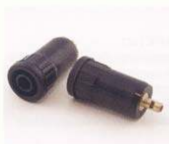
BU 4701 Sicherheitseinspreßbuchse innen 4 mm Ø mit Flansch 13,2 mm Ø zum Einpressen in Montagebohrungen von 12,0 mm Ø, Buchse aus Messing gedreht und vernickelt, mit Lötanschluß, in den Farben schwarz, rot, blau, gelb, grün und gelbgrün.
