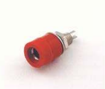
BU 4400 S Buchse innen 4 mm Ø, Polyamid umspritzt mit rundem Kopf 10 mm Ø außen, für Frontplattenmontage bis 3 mm Wandstärke und Lötanschluss, sowie Außengewinde M 6x0,75 montiert mit Unterlagscheibe und Mutter, Metallteile Messing vernickelt.
