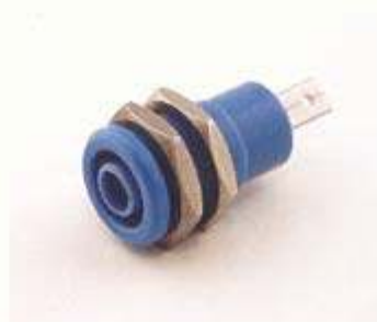
BU 4600 Sicherheitsbuchse innen 4 mm Ø mit Flansch 14 mm Ø und Gewinde M 12x0,75 zum Einschrauben, einschließlich zwei Muttern, Buchse aus Messing gerollt und vernickelt, mit Flachstecker 4,8x0,8mm, auch lötbar, in den Farben schwarz, rot, blau, gelb, grün, gelbgrün und weiß.
