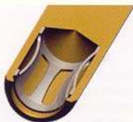
Federkorbkontakte an Steckern und in Buchsen fertigen wir stufenlos ab 1,0 mm Ø aus hochwertigem Kupferberyllium für dauerhafte Elastizität und beste Kontakteigenschaften.
