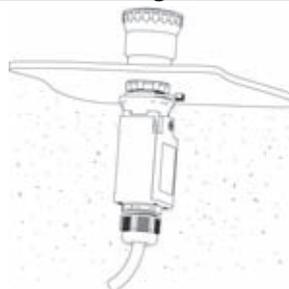
Geschützte Kontakteinheit für Meldegeräte, die im Schaltpult mit Staub verwendet sind.
